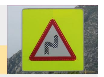
Señales luminosas o reforzadas por led, fabricadas tipo cajón en perfil de aluminio con cara trasera de aluminio y raíles para fijación a soporte, cara delantera de policarbonato, y rotulación con reflectante RA2 prismático translúcido, con sensor crepuscular y regulador de intensidad, alimentadas por red 220V o panel solar y soporte en tubo de aluminio estriado.
